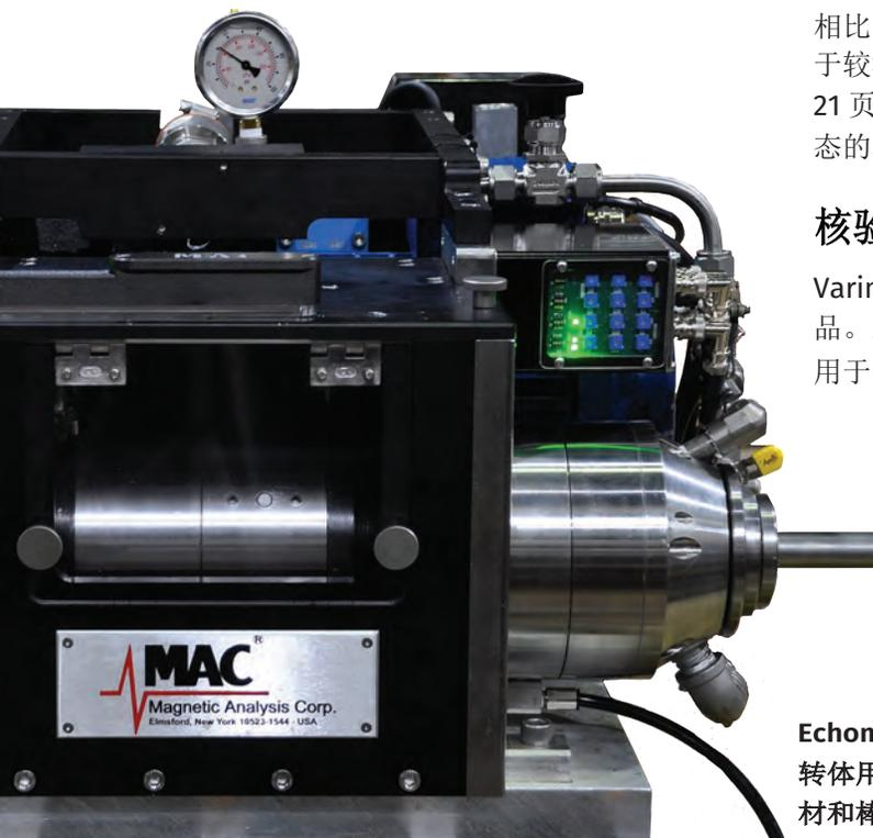
Echomac® UT 25mm 超声波旋转体用于检测高精小直径管材和棒材。
