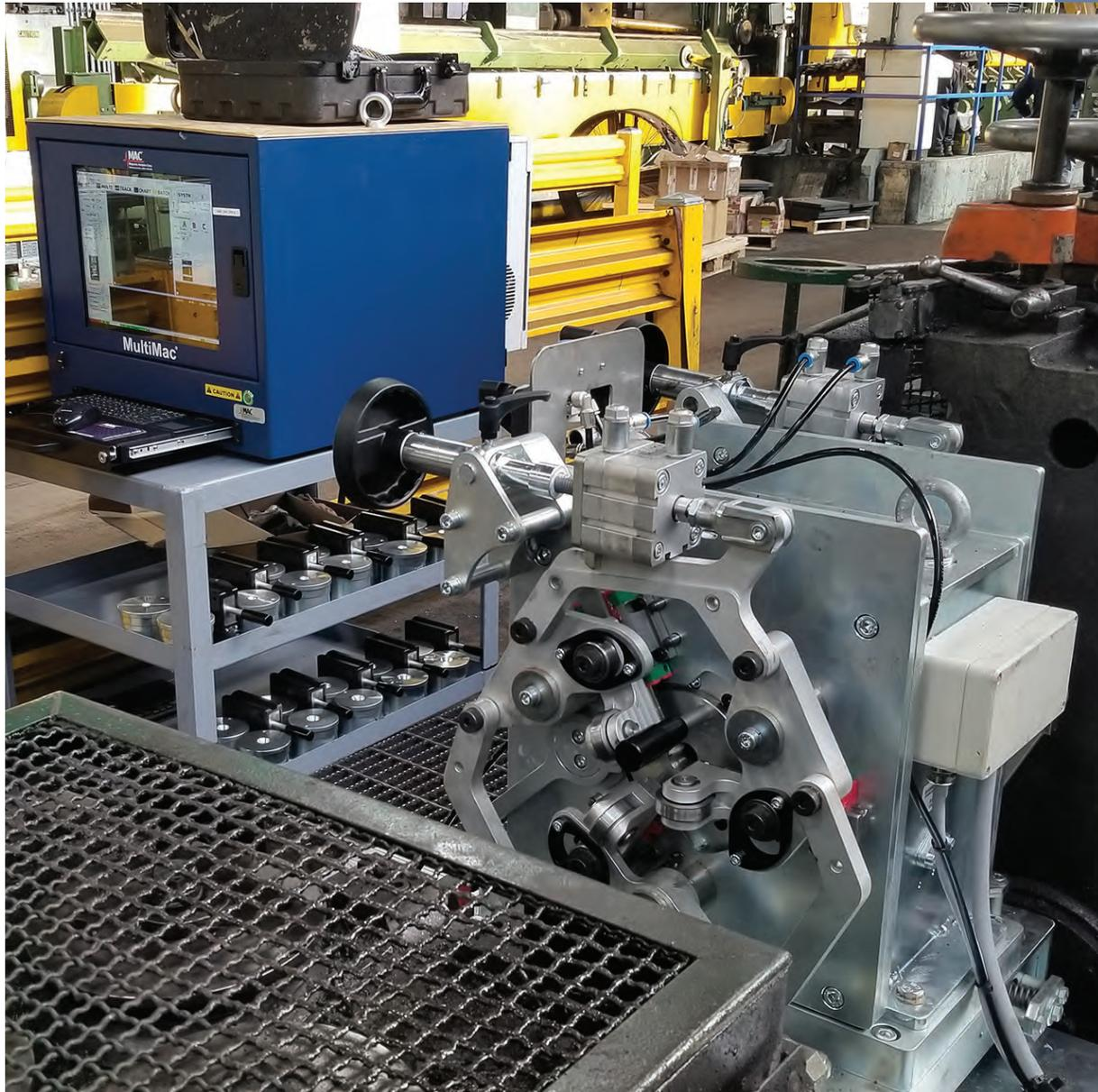
MultiMac® 涡流检测系统安装于舒马格 (Schumag) 联合拉拔机组上用于检测六边形和圆形棒材。该系统配备 CP 65mm “浮动式” 探头平台，其进出口均带有气动三轮导辊。
