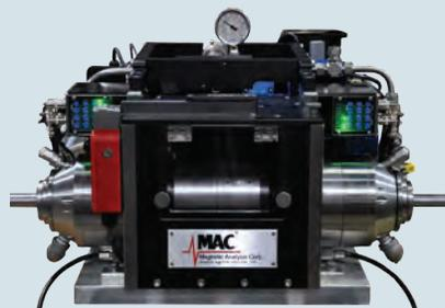
高精度小直径管材和棒材超声检测
