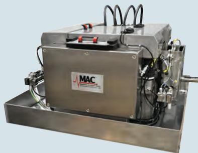
实现圆棒内部和表面缺陷 100% 检测
