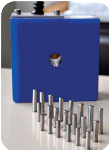
Bobina de prueba típica y pinos con longitudes de 3/4", 1" y 1 1/4" utilizados para generar las señales mostradas en la pantalla superior derecha.
