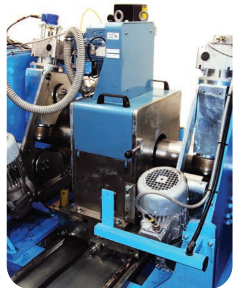
Cabezal rotativo con electrónica MultiMac, para Inspección de barras laminadas en caliente de 50 mm a 150 mm de diámetro. El sistema incluye una mesa con rodillos triples y un equipo de ultrasonido Echomac®.
