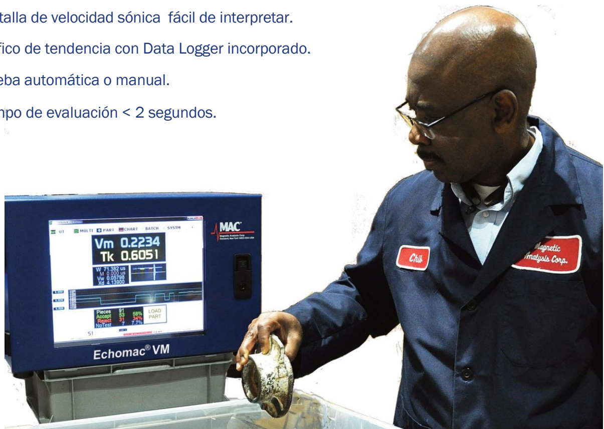
Pantalla A-scan mostrando los resultados de la prueba de una pieza
