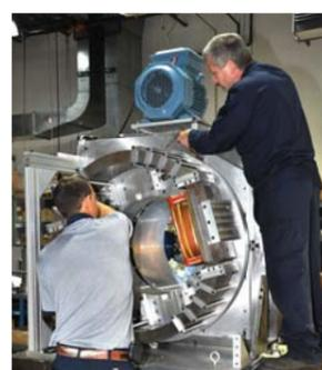
MAC-Techniker montieren die jüngste Version der Rotoflux® Streufussprüfanlage, mit der Produkte für die Öl- und Gasindustrie eines Kunden in Russland getestet werden
