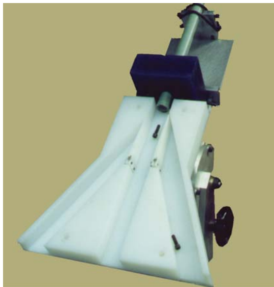
Sistema de Separação modelo 570, com alimentador vibratório para alimentação de peças e separação em três grupos.
