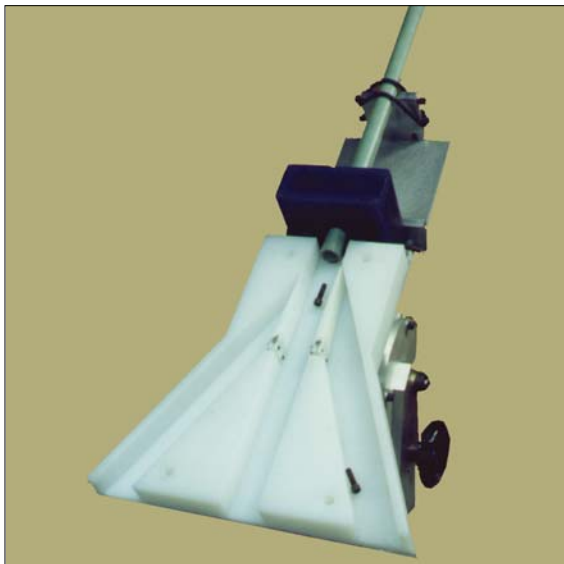
Système d'éjection modèle 570. Un bol vibrant alimente les pièces au travers de la bobine et celles-ci sont éjectées sur l'une des trois voies selon spécifications.
