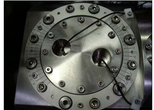
Support de transducteur pour mode transversal avec mécanisme d'offset simple, à droite.
