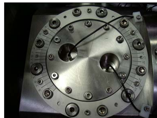
На рисунке справа показан держатель для преобразователей, работающих на поперечных волнах, с простым механизмом смещения.
