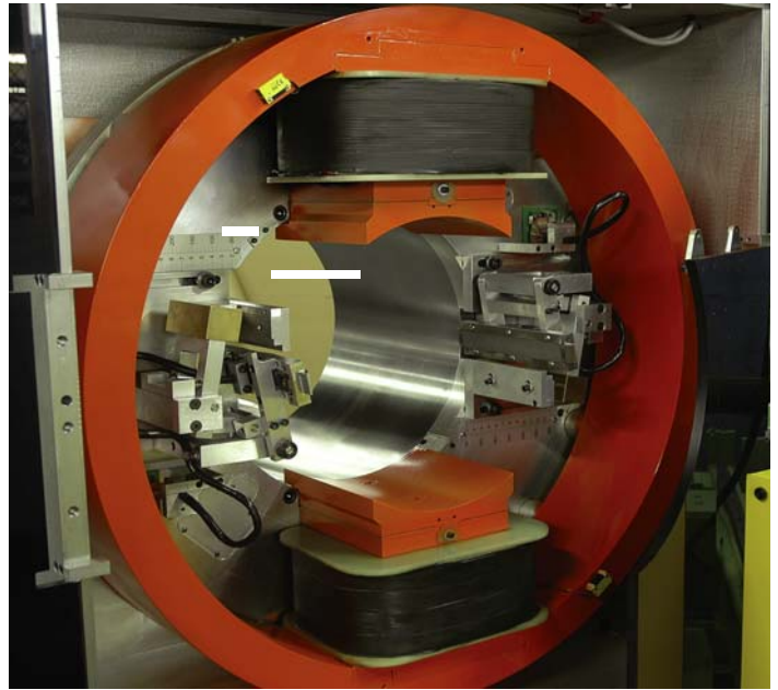
Assemblage de la tête rotative Rotoflux® avec les bobines de magnétisation en haut et en bas. Les blocs sondes qui renferment les éléments de test sont visibles des deux côtés. Le système rotatif est utilisé pour détecter des défauts longitudinaux tels que fissures, repliures et défauts de soudure
