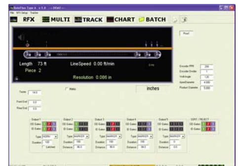
Ecran de suivi pour réglage du codeur et autres données temporelles pour l'élimination d'extrémités
