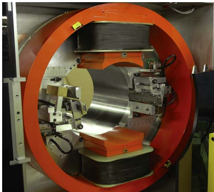
Rotoflux 旋转式磁头板组件两边各带有磁性线圈。容纳检测探头的探头组件被显示在顶端和底部。旋转系统用于纵向检测缺陷诸如裂缝、折叠和焊缝缺陷。
