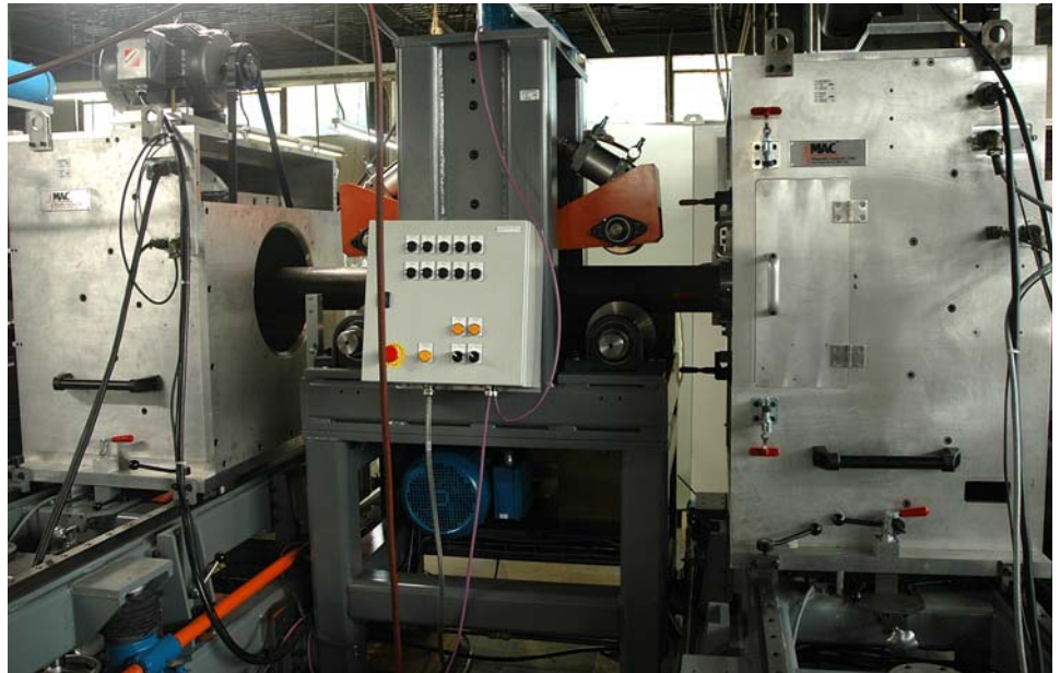
ROTOFLUX 900型旋转漏磁设备。横向及纵向旋转漏磁检测系统，主要用于检测厚壁管内外表面的横向和纵向缺陷。
