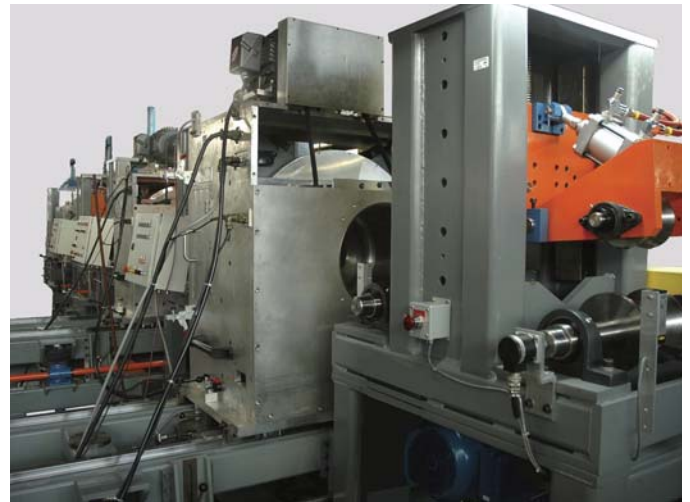
Dispersion de flux Rotoflux® RFX et TFX avec ultrasons Echomac® sur banc à galets en V
