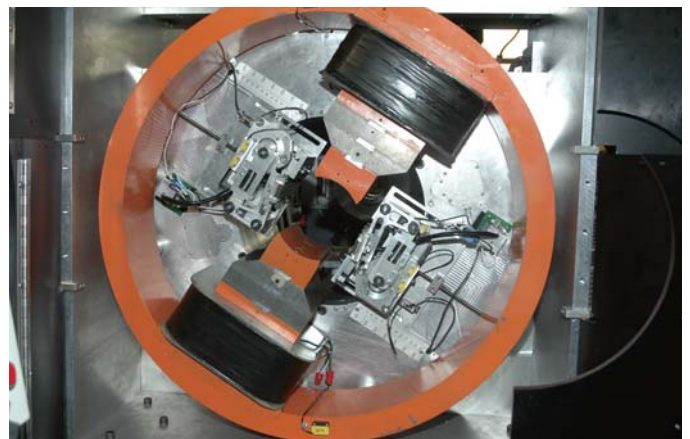
RFX pour défauts longitudinaux
