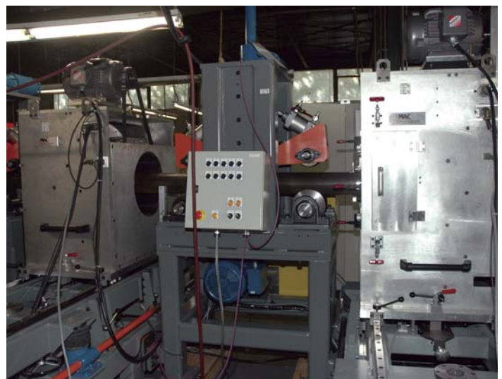
Système à dispersion de flux TFX transverse et RFX longitudinal
