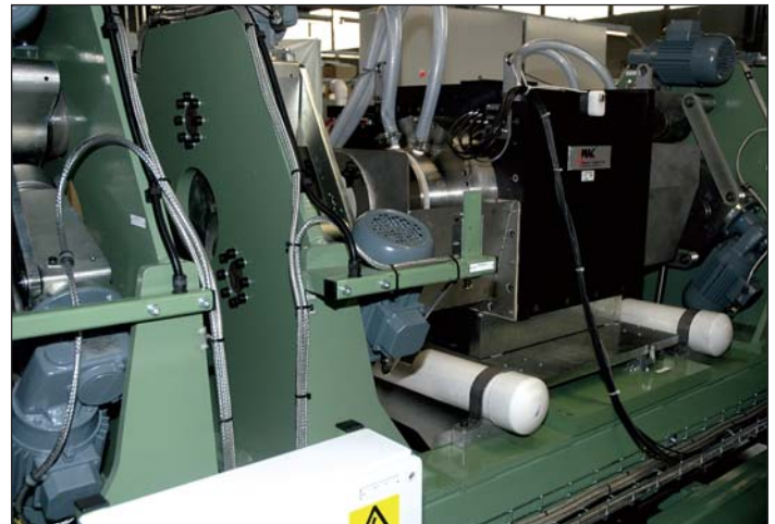
Système de contrôle ultrasons sur banc à centre constant et galets tripodes
