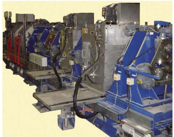
Système multitest dispersion de flux et ultrasons sur banc à galets tripodes comme décrit à gauche
