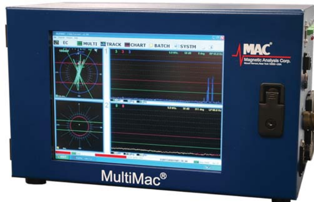
Tela Multi do MultiMac SM mostrando simultaneamente os displays polar e linear de dois canais de teste.
