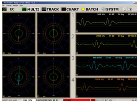
MultiMac 多屏幕同时显示4条信道的极性 & 线性画面。最多8条通道，具有全部阈值，均可同时显示。
