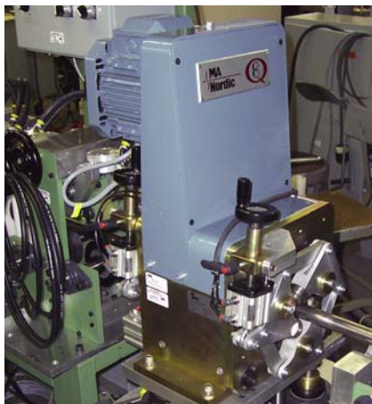
La tête de contrôle Rotomac® E-Rotary ci-dessus, peut contrôler tube, barre ou tige en continu tel que sur banc d'étirage, frappe à froid ou dressage et coupe. Le contrôle peut s'effectuer automatiquement avec identification des pièces défectueuses qui sont alors marquées ou éjectées en aval après coupe et frappe à froid. Des modèles pour faible diamètre sur fil ou tige sont également disponibles.
