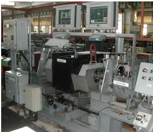
Sistema MAC para inspeção de tubos incluindo um Cabeçote Rotativo Echomac, montado sobre uma mesa de elevação, um equipamento de ensaios por correntes parasitas (eddy current) com bobina envolvente e um desmagnetizador para diminuir o magnetismo residual.
