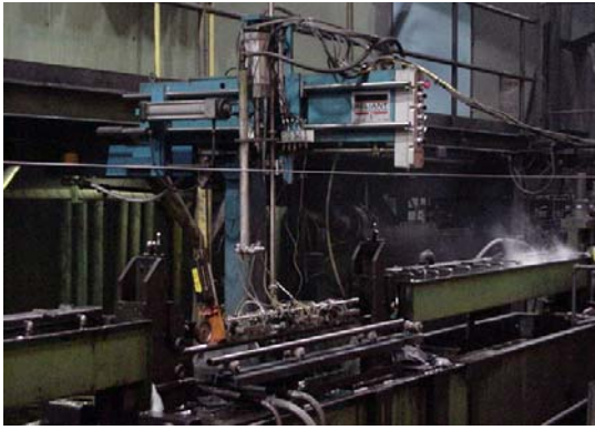
Estação de inspeção ultra-sônica com eletrônica Echomac numa linha de solda de tubos na empresa Wheatland Tube, Arkansas, USA, com acoplamento por jato de água (squiter).
