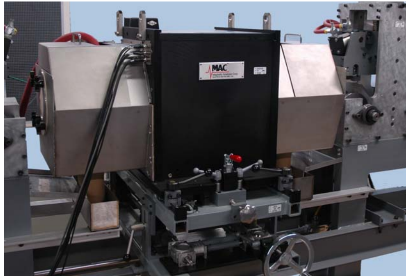
Sistema rotativo Echomac de 7 canales montado sobre una mesa de elevación, para inspeccionar material con diámetro hasta 4" (101.6mm). Los transductores rotativos se encuentran dentro del cabezal negro, el cual también contiene el agua a presión para acoplamiento.
