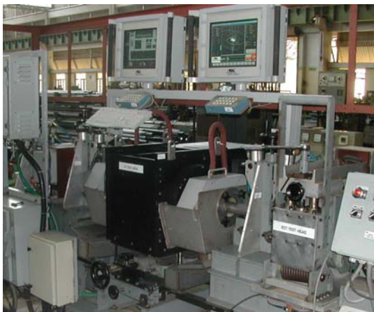
Sistema MAC para inspección de tubos incluyendo un Cabezal Rotativo Echomac, montado sobre una mesa de elevación, un equipo de ensayos por corrientes inducidas con bobina envolvente y un desmagnetizador para disminuir el magnetismo residual.
