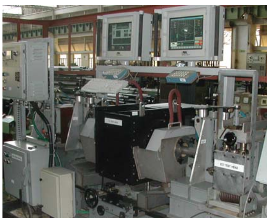
Дефектоскоп Echosac с вращающимися преобразователями, расположенный на подъемной платформе, устройство размагничивания для удаления остаточной намагниченности, вихревой контроль с помощью проходной катушки.
