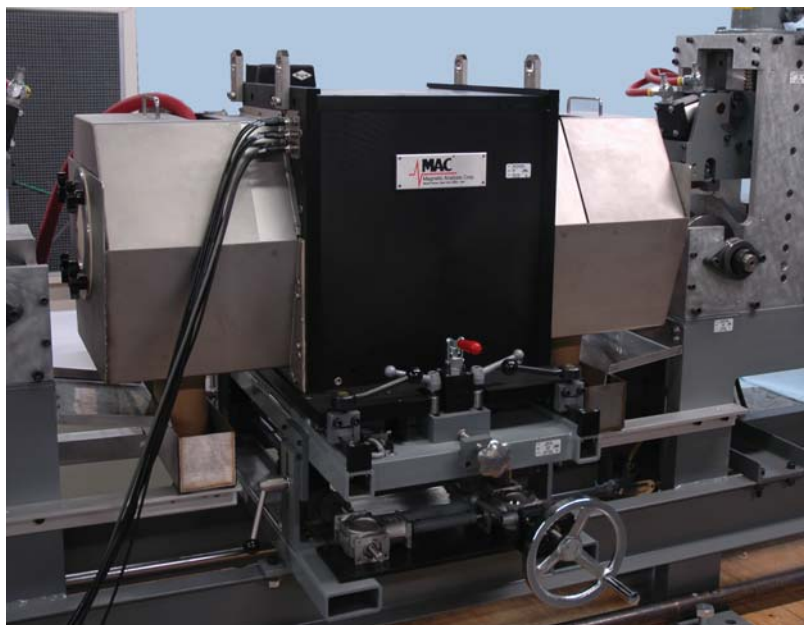
Семиканальный ультразвуковой дефектоскоп Echosac, расположенный на подъемной платформе, предназначен для контроля изделий диаметром 101,6 мм. Вращающиеся преобразователи расположены в черном корпусе, в котором также находится вода под давлением (в качестве контактной среды).
