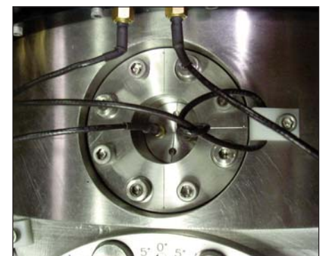
带有简单偏置机构的剪切波模式传感器支座 如右图所示
