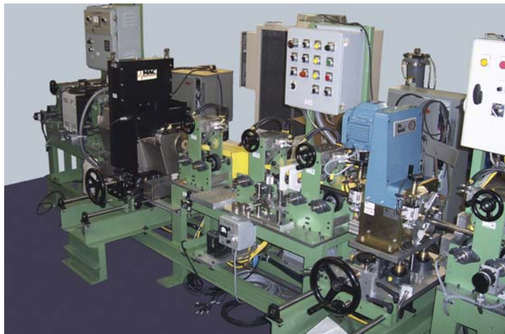
Sistema para detecção de defeitos em barras composto de cabeçotes rotativos para ensaios por correntes parasitas e ultrassom e desmagnetizador para eliminar o magnetismo residual, montados numa mesa central de teste com rolos triplos da MA Nordic.
