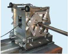
Suporte de Bobinas de 65 mm, com eletroímã para saturação magnética para ensaios por correntes parasitas com bobinas envoltivas ou segmentadas.
