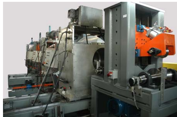
Sistema combinado de ensaios por Ultrassom e Campo Magnético de Fuga para inspeção de tubos de grandes diâmetros e espessuras de parede tipo OCTG. O sistema inclui três cabeçotes rotativos, um de Ultrassom e os outros dois para detecção de defeitos longitudinais e transversais por Campo Magnético de Fuga.
