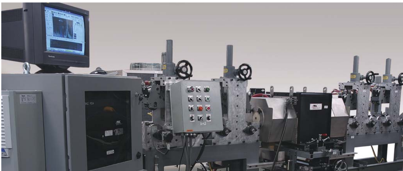
Sistema de ultrassom até 4" de diâmetro. A eletrônica FD-4 aparece à direita. Transdutores rotativos no interior do compartimento preto com acoplamento por água em ambos os lados. Rolos compressores acionados posicionam e movimentam o material ao longo da linha.
