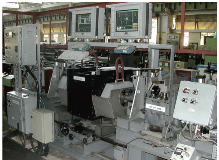
Sistema combinado de ensaios por correntes parasitas com bobina envolvente e ultrassom para tubos de aço com costura. A bobina de correntes parasitas aparece na direita e os transdutores de ultrassom na caixa preta no centro. Os monitores do Echomac FD-4 e do aparelho de correntes parasitas aparecem na parte superior central.
