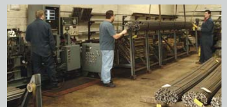
Barras de aço sendo ensaiadas por correntes parasitas na planta da MAC em Ohio. Entre em contato com a planta da MAC em Boardman, Ohio (330) 758-1367
