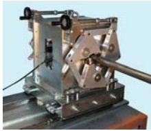
Portabobina da mm65 di capacità interna per essere usato con bobine avvolgenti o a settore per correnti indotte; usa un elettromagnete per saturare i materiali magnetici.
