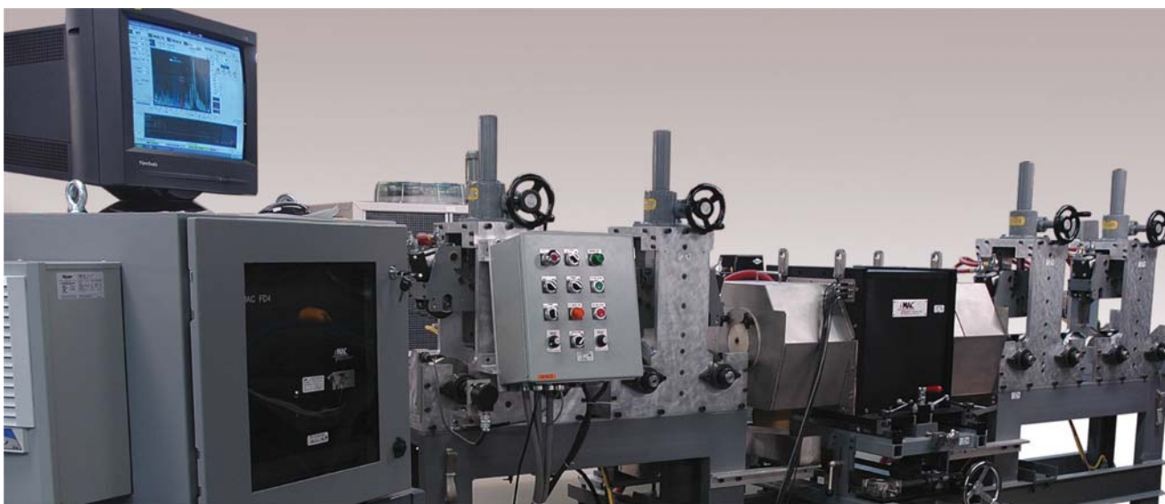
Un sistema di ispezione ad ultrasuoni per diametri fino a 100mm; L'elettronica FD-4 è mostrata a sinistra. I trasduttori rotanti sono alloggiati all'interno dell'involucro nero che accoglie l'acqua per l'accoppiamento su entrambi i lati. I rulli inferiori e superiori mantengono e guidano il materiale attraverso il test
