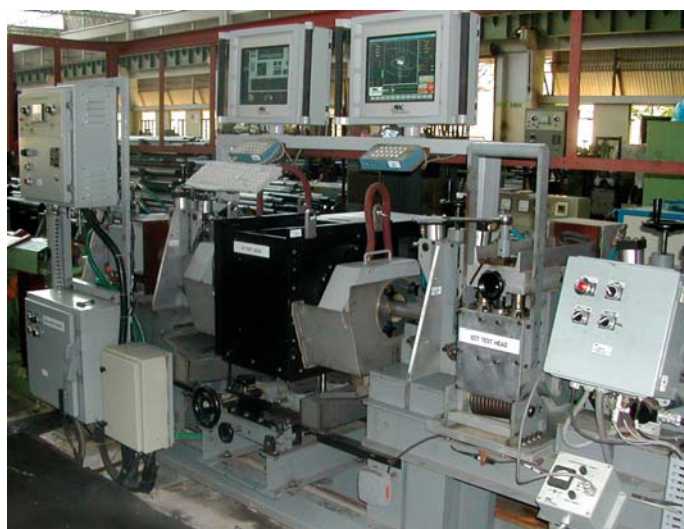
Sistema combinato di prova con bobina a correnti indotte e testa rotante ad ultrasuoni. La bobina a correnti indotte è sulla destra, con una maniglia alta per il posizionamento off-line; i trasduttori UT sono all'interno dell'involucro nero, posizionati nel rotore. I monitor per il controllo dei segnali derivanti dalle sonde di ispezione sono posizionati in alto, al centro del bancale di test.
