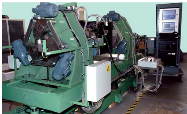
Bancale di trasmissione a centro costante con triplete
