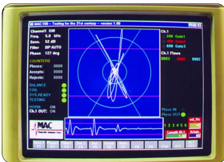
Pantalla del MAC 150/175. En el lado derecho se muestran los ajustes de los umbrales de detección. En el lado izquierdo, los ajustes de frecuencia, sensibilidad, fase y filtro, así como los contadores y las luces de control operacional del sistema. En el centro se muestra el gráfico polar y abajo el lineal.
