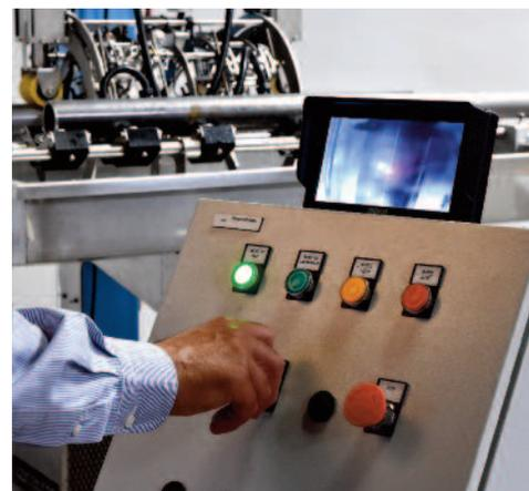
*A estação remota do operador inclui os controles essenciais e o monitor para verificar a posição dos transdutores com relação à solda e o controle tipo “joystick” para efetuar os ajustes.*
