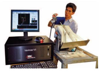
Comparador Varimac com Bobina de Teste e Sistema de Separação 570
